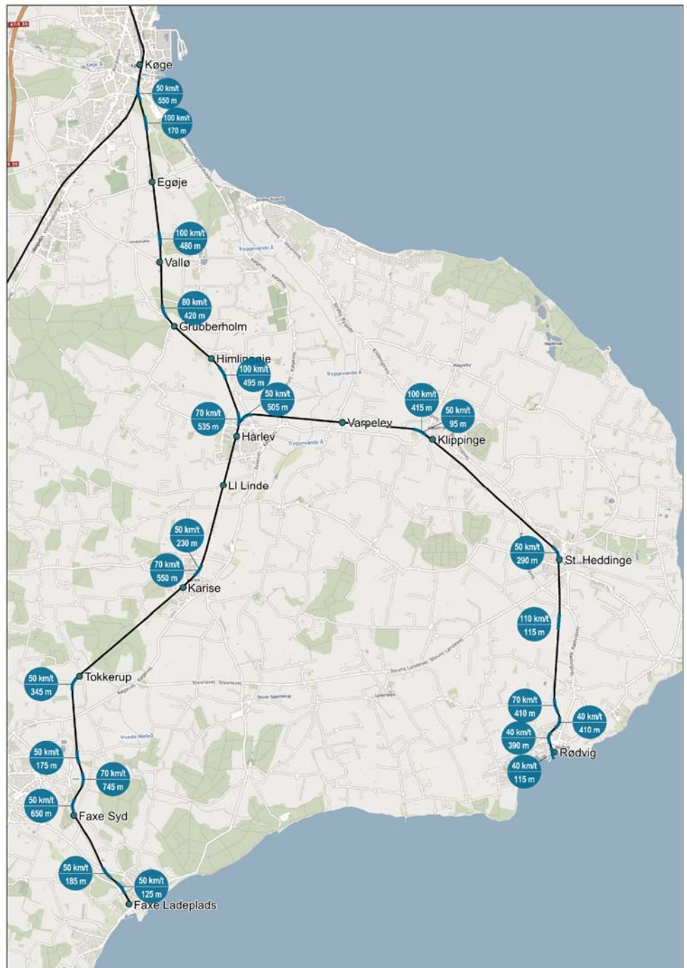
Figur 12 Anbefalede hastighedsgrænser i kurver med en BRT på Østbanen
