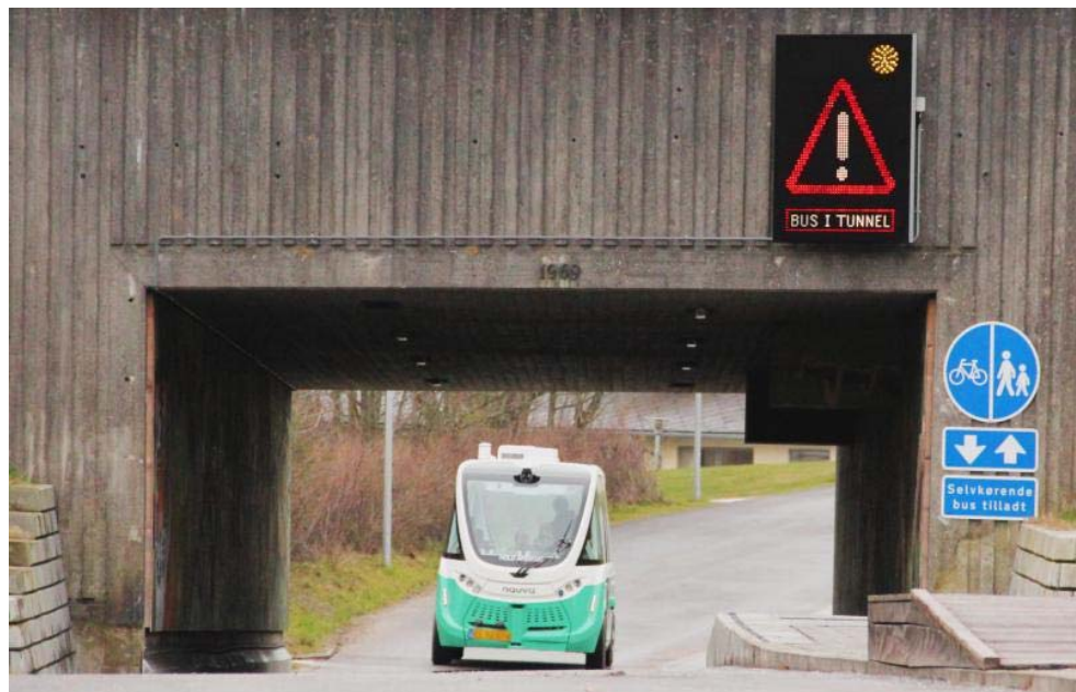
Figur 25 Forsøgsstrækning med autonom bus i Aalborg – maks. 18 km/t. (foto: ITS Teknik)
