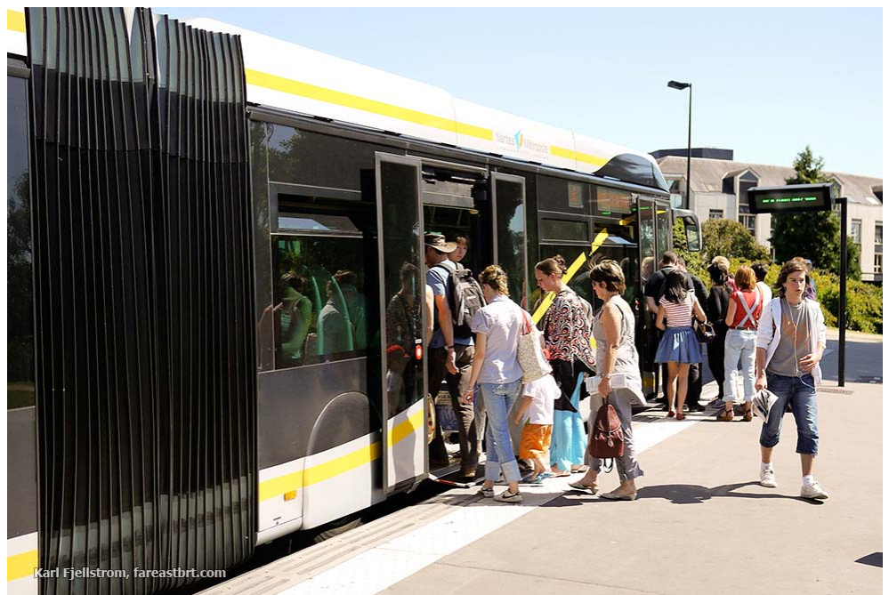
Figur 2 I BRT-systemet i Nantes er der etableret niveaufri ind- og udstigning fra perronerne. Det er praktisk for alle rejsende og reducerer ekspeditions-tiden ved stoppesteder, hvor der er stor passagerudveksling. Foto: Karl Fjellstrom
