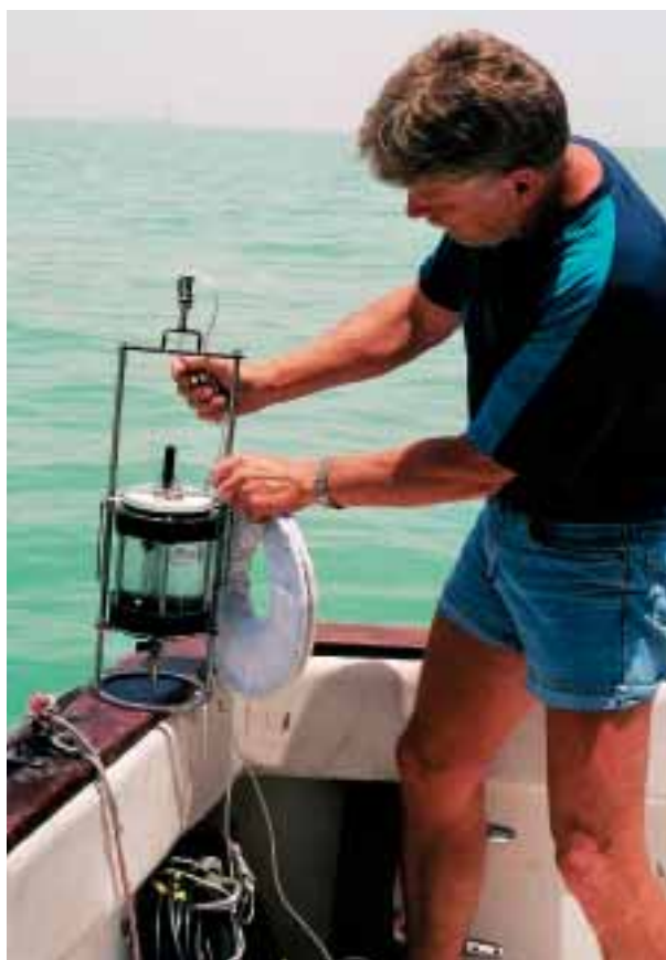
Vandprøve for kalibrering af turbiditetsmåler
