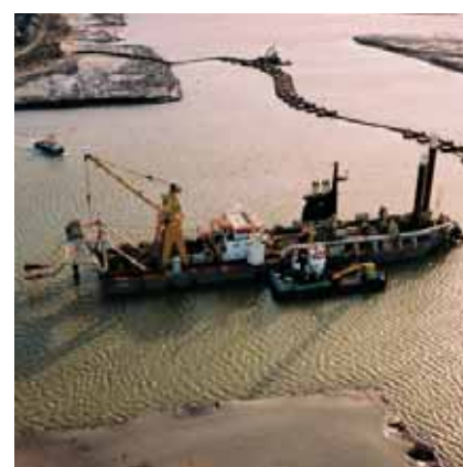
Eksempel på hydraulisk gravemaskine af skære-sugetyperen (cutter-suction dredger)
