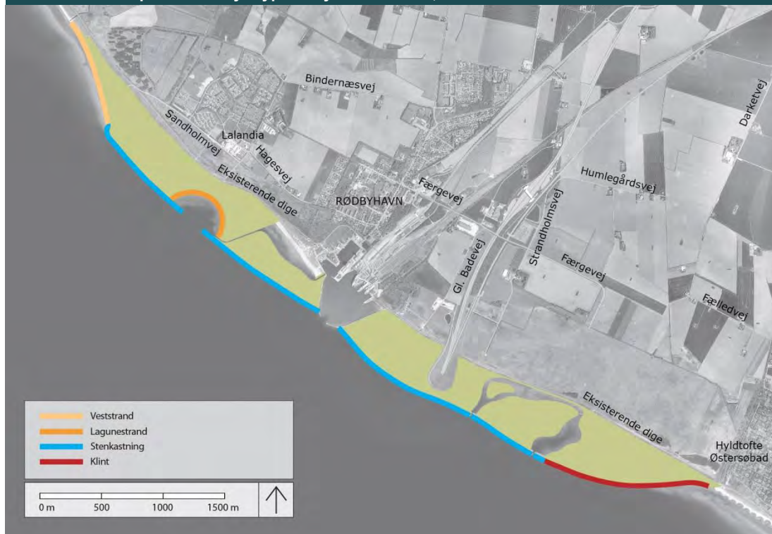
FIGUR 2.39 Principskitse for kysttyper – nyt landområde, Lolland
