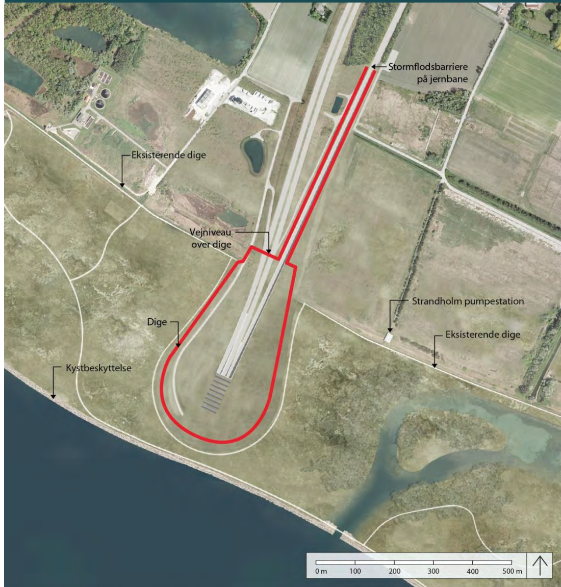
FIGUR 2.27 Portal- og rampeområdets hovedelementer på Lolland
